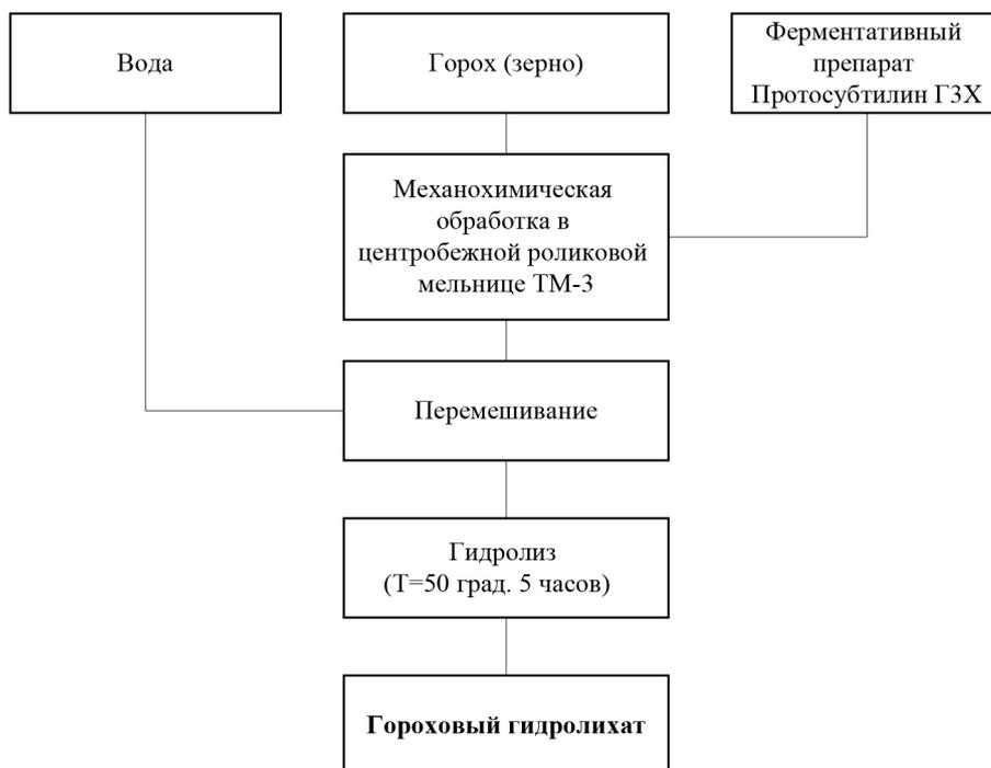
Рисунок 3. Технологическая схема приготовления горохового гидролизата.
