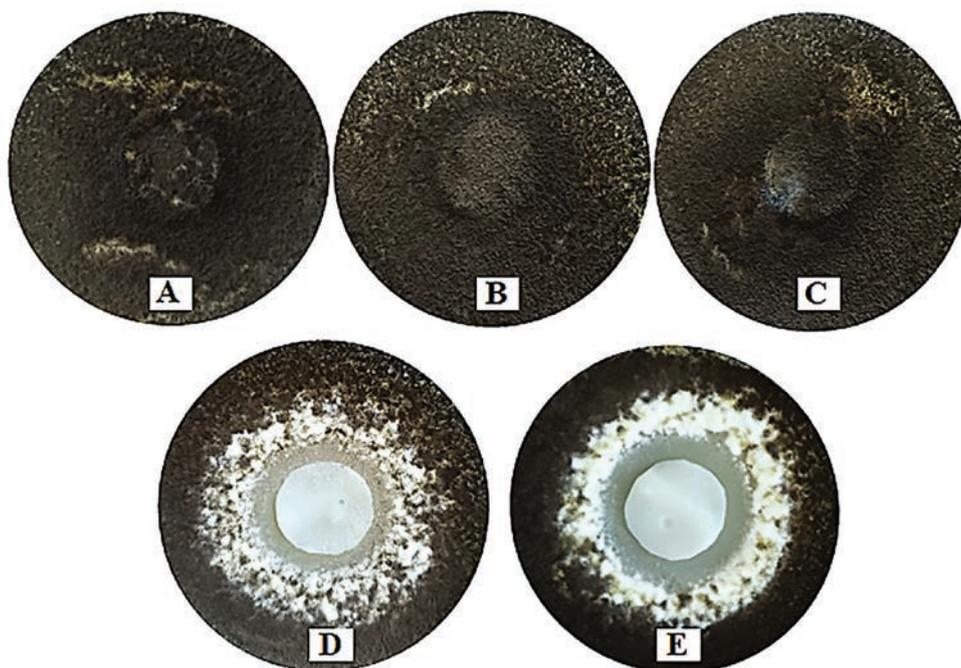
Примечание: А – контрольный образец без антимикробной добавки; В – образец с концентрацией гвоздичного масла 0,5 %; С – образец с концентрацией гвоздичного масла 1 %; D – образец с E – образец с концентрацией гвоздичного масла 5 %
