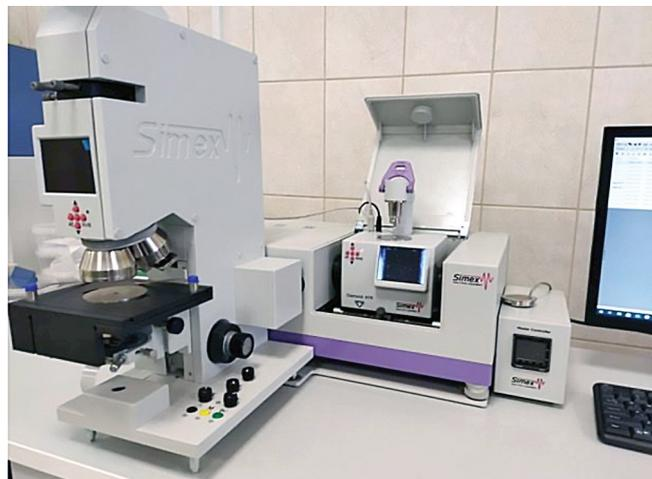
Фурье-спектрометра ФТ-801 (Симекс, Россия) с микроскопом МИКРАН-3 (Рисунок 2).
