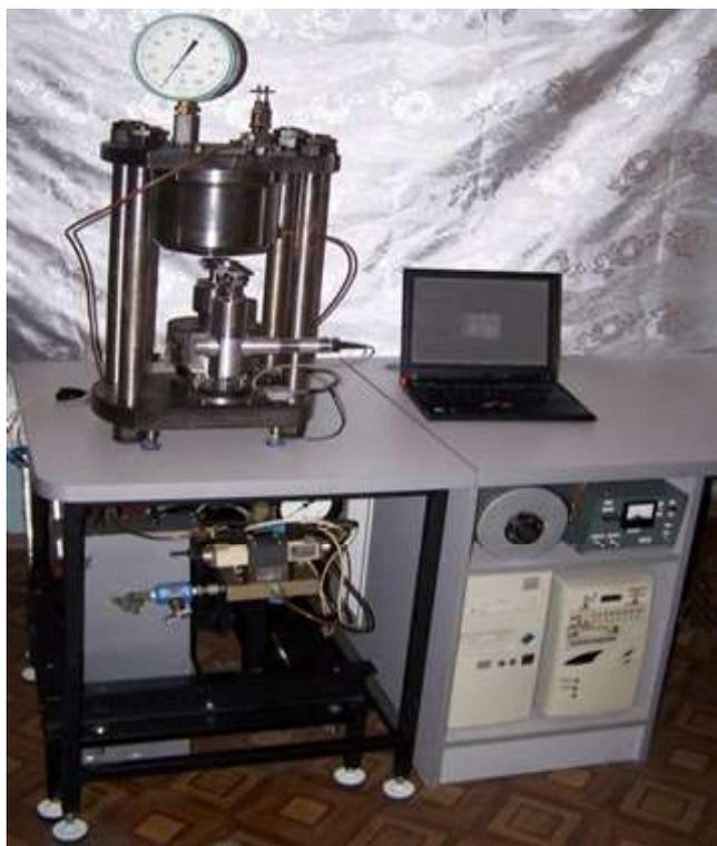
Рисунок 1. Общий вид установки высокого давления второго поколения
