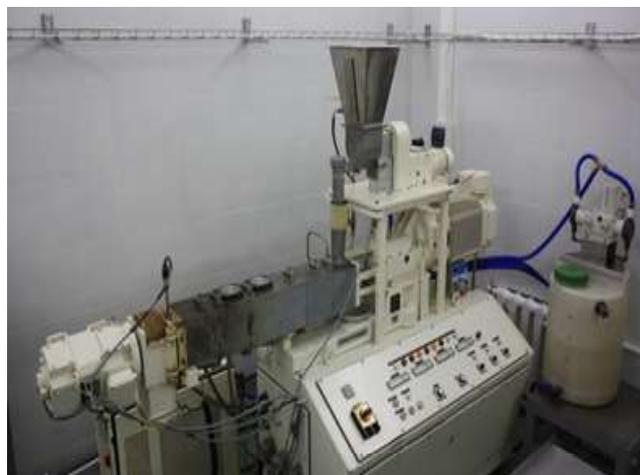
Рисунок 1. Экспериментальная установка на основе экструдера Werner&Pleiderer Continua 37
