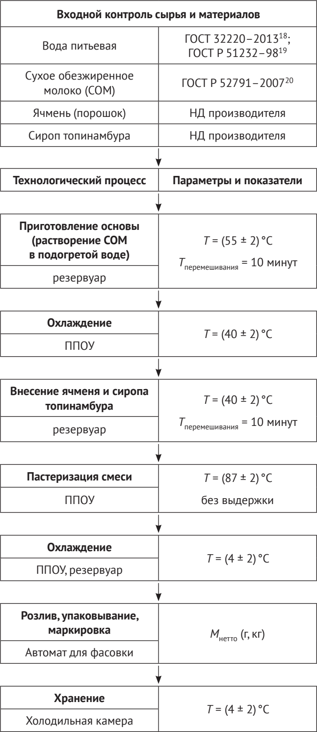
Рисунок 4 Технологическая схема производства молочного напитка с ячменем
