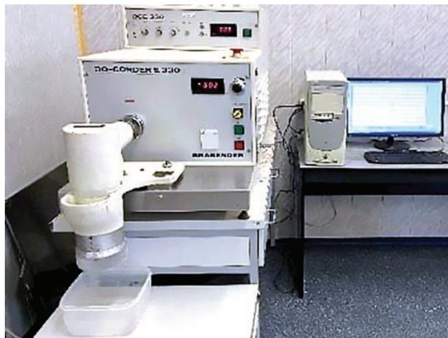
изделия с усилием 6,8 г, помещенного на две опоры столика с расстоянием  $l$ , мм, которое обусловлено диаметром  $d_m$  макаронных изделий ( $l = 10d_m + 30$ ). Диаметр макаронных изделий 5 мм.
