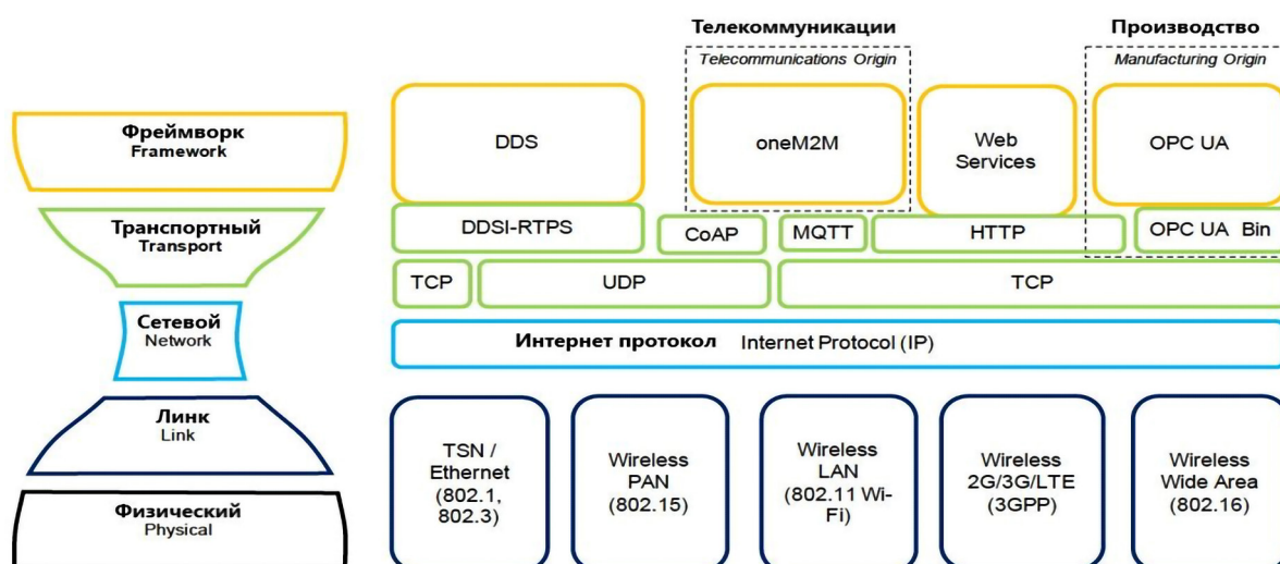
Рисунок 8 Сетевой стек и протоколы передачи данных IIoT платформы Figure 8 Network Stack and Data Transfer Protocols of the IIoT Platform
